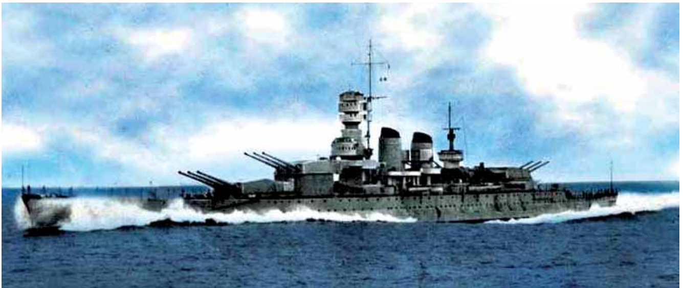
Una bella immagine d'epoca, colorata, della nave da battaglia Littorio (ribattezzata Italia dopo l'8 settembre), la cui classe venne dotata sia dei cilindri assorbitori che del nuovo modello di torrione concepito dallo stesso Pugliese
